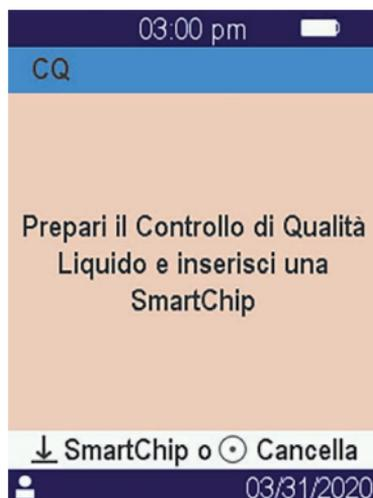
Fare riferimento alle istruzioni per l'utilizzo del LQC per preparare il campione prima di inserire lo SmartChip corrispondente al controllo di qualità da eseguire. Quando il campione è pronto, procedere nello stesso modo in cui si trattava di eseguire un test di routine.
