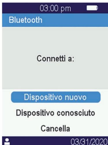
**3.** Selezionare «Nuovo dispositivo». Quando si collega un nuovo dispositivo, sullo schermo viene visualizzato un codice PIN a 6 cifre preceduto dalla dicitura «in attesa di connessione». Per esempio:
