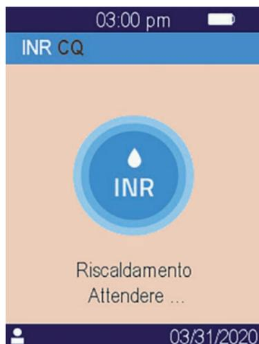
Dopo il riscaldamento, all'operatore viene richiesto di far cadere un paio di gocce di LQC sulla piastra curva del Tsmart® per eseguire il test di controllo qualità:
