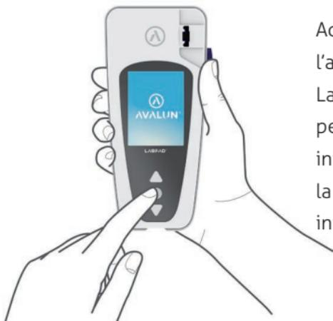
Accendere il dispositivo premendo l'apposito pulsante centrale. Quando LabPad® Evolution viene avviato per la prima volta, il processo di inizializzazione inizia subito dopo la visualizzazione della schermata iniziale.
