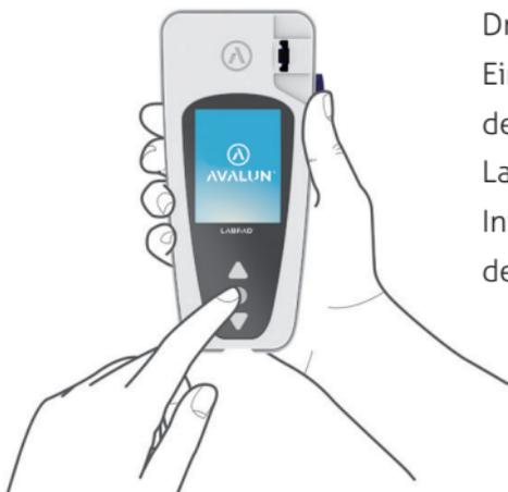
Drücken Sie zum Einschalten die Ein/Aus-Taste in der Mitte. Bei der ersten Inbetriebnahme des LabPad® Evolution beginnt der Initialisierungsprozess direkt nach der Anzeige des Startbildschirms.
