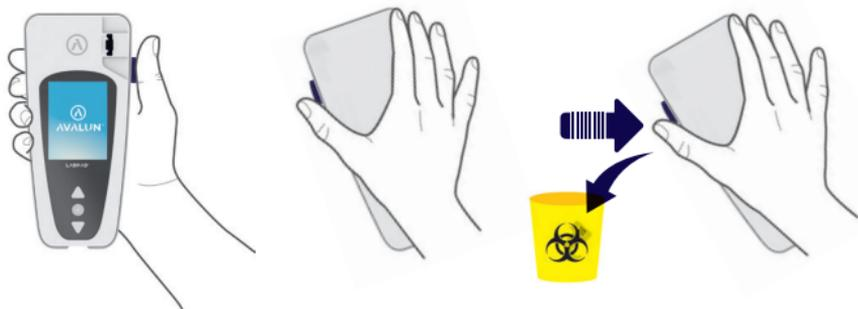
Zur Minimierung des Kontaminationsrisikos wurde dieses einzigartige Auswurfsystem so konzipiert, dass der Benutzer niemals mit einem gebrauchten SmartChip in Berührung kommt.
