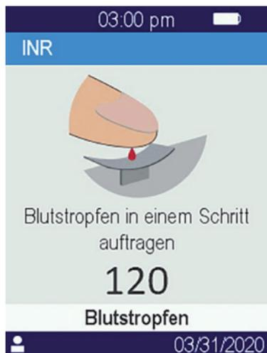
Stechen Sie seitlich in eine Fingerspitze des Patienten. Zur Füllung des zentralen Mikrokanals ist ein Mindestvolumen von 3µl Blut erforderlich. Üben Sie keinen starken Druck auf den Finger aus, da dies zu falschen Ergebnissen führen kann.
