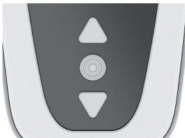
Verwenden Sie bei allen Schritten die dreieckigen Tasten, um nach oben oder unten zu navigieren und die entsprechende Option auszuwählen, und die mittlere Ein/Aus-Taste, um zu bestätigen und weiter zum nächsten Schritt zu gehen.
