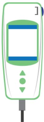
O LabPad® INR funciona com bateria ou ligado a uma fonte de alimentação elétrica. Para ligar à rede, conectar o cabo fornecido na porta micro USB localizada na parte inferior do dispositivo e o carregador de bateria (adaptador) numa tomada de corrente. O cabo fornecido é conforme o padrão CEI 61010.
