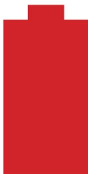
Quando a bateria é exibida a vermelho em grande ecrã, significa que a bateria está em estado crítico e que o dispositivo será desligado automaticamente.
