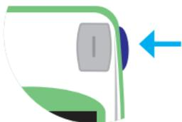
O botão azul lateral solta a Tsmart® INR para descartá-la após o uso (ver secção 5.5 Descarte da microcuvette).
