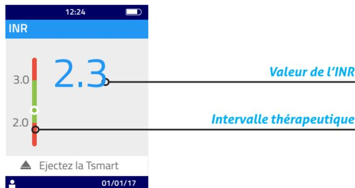
Lorsque le résultat de la mesure d'INR se situe dans l'intervalle thérapeutique défini, l'indicateur rond ● se situe dans la zone verte; à l'inverse, lorsque le résultat est en dehors de l'intervalle, il est dans la zone rouge ●.
