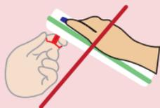
Ne pas tirer sur la Tsmart® INR, vous risquez d'endommager la microcuvette et d'en laisser une partie à l'intérieur de l'appareil.
