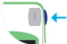
Le bouton bleu sur le côté droit de l'appareil débloque la Tsmart® INR pour permettre son éjection après usage (Cf. chapitre 5.5 « Ejection de la Tsmart® INR »).
