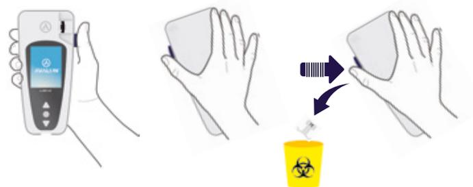
Para minimizar el riesgo de contaminación, este sistema de extracción único ha sido diseñado de tal modo que el usuario no tiene nunca contacto con un SmartChip usado.
